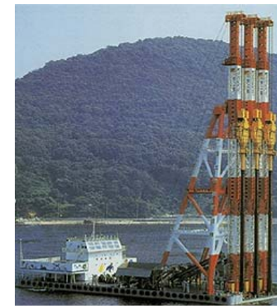
SCP船(地盤改良)
